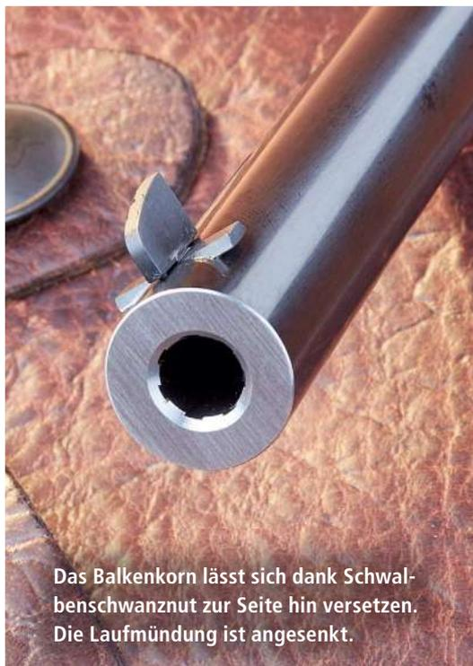
Das Balkenkorn lässt sich dank Schwalbenschwanznut zur Seite hin versetzen. Die Laufmündung ist angesenkt.
