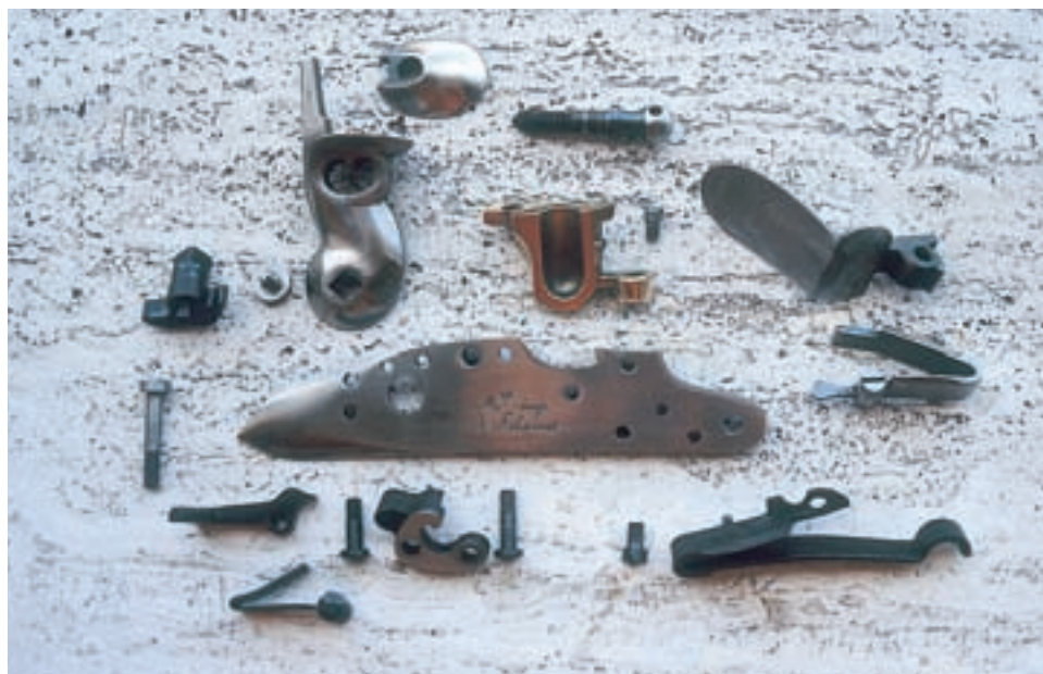
Sopra: lo smontaggio dell'arma comincia dal bocchino, asportabile, sfilandolo anteriormente, dopo averlo liberato dalla vite di fissaggio, in comune all'acciarino.
