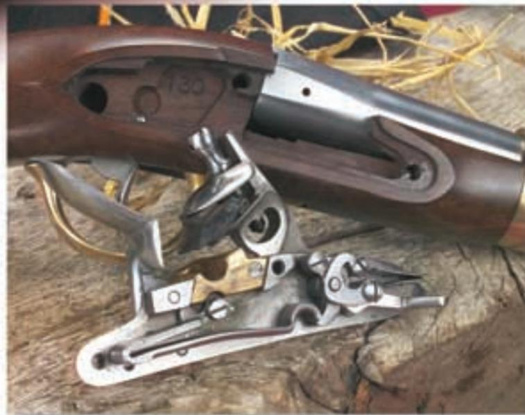
aus war der obere Schenkel der Batteriefeder nicht geknickt und die Schloßplatte vorn leicht nach unten gezogen. Die Mortise wurde hier stärker ausgeschnitten, so daß der hölzerne Grat um das Schloßblech mehr zur Geltung kam. Der An IX-Replika fehlt die kleine Nase des Originals vorn am Laufring.
