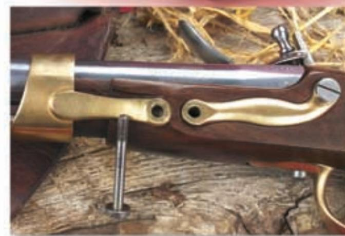
Bei der An XIII ist der Laufring mit dem Schloßgegenblech verschraubt, das genau dem der An IX entspricht. Die nur halbgeschäftete Waffe ist eine Spur leichter. Sie war einfacher herzustellen, und ihr Laufring blieb vor Verlust gesichert.
