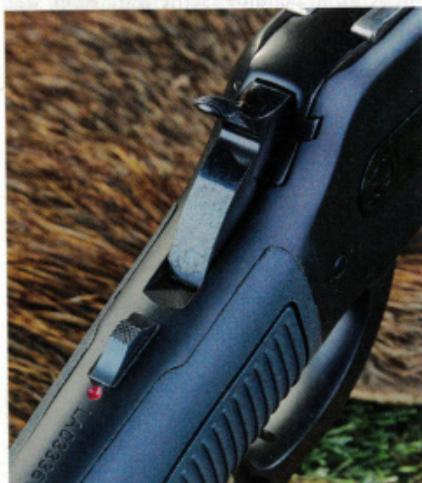
Steht der Sicherungsschieber auf dem Kolbenhals hinten, sind Hahn, Abzug und Lever blockiert, steht er vorn auf Rot, ist die Büchse schussbereit.
