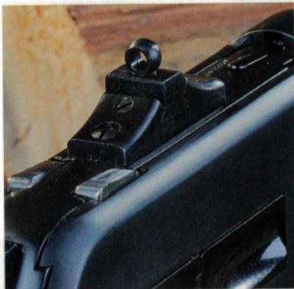
Auf dem Verschluss der Pedersoli-Testwaffe prangt ein Ghost Sight, also eine Lochkimme, in diesem Fall höhen- und seitenverstellbar.
