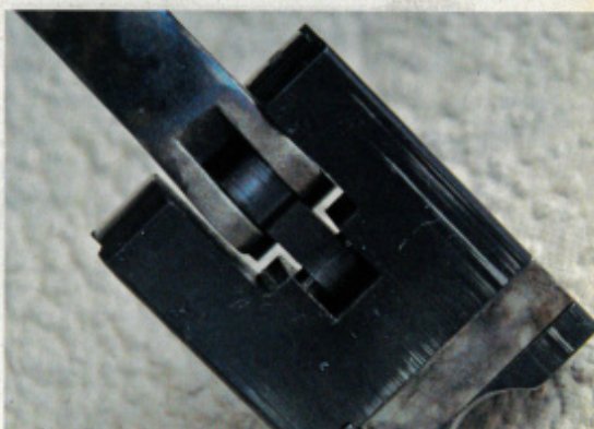
La bielletta che lega leva e otturatore
