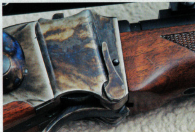
L'estremità del perno della leva ha una maniglia per poterlo sfilare
