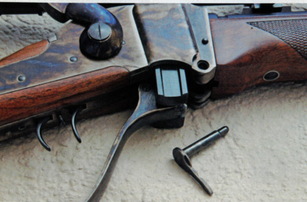
A perno sfilato, l'otturatore scende oltre la posizione abituale e si può rimuovere
