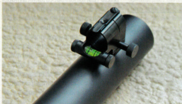
Sul porta mirino a tunnel, una livella a bolla d'aria assicura la verticalità del piano che interseca le mire
