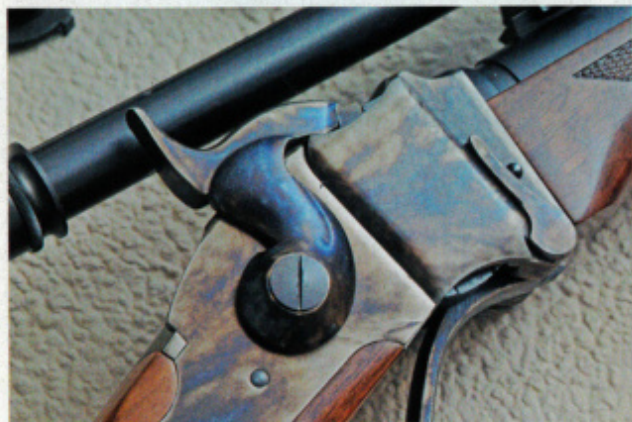
Il cane è massiccio ma la sua caduta non sposta l'arma
