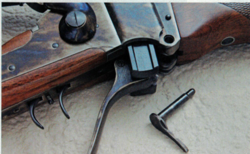
A perno sfilato, l'otturatore scende oltre la posizione abituale e si può rimuovere
