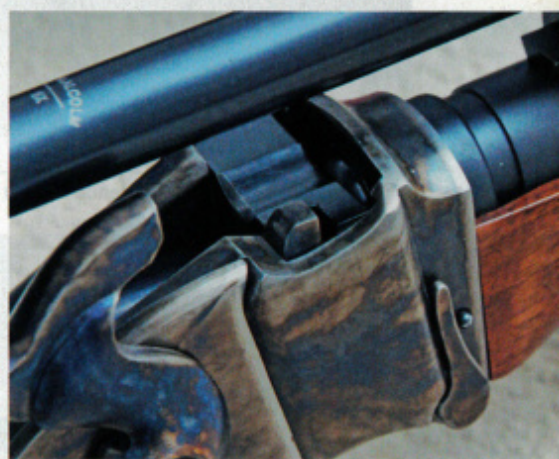
Si vede l'estremità dell'elemento che aziona il percussore
