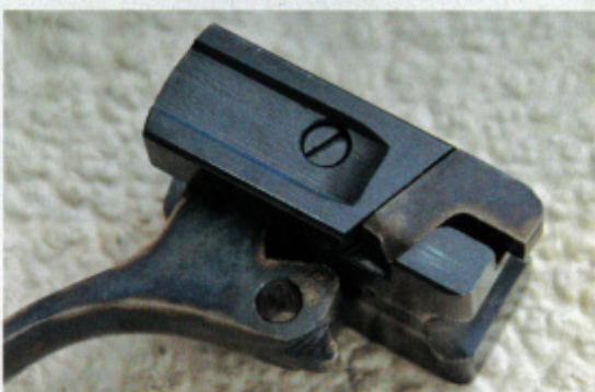
L'elemento colpito dal cane può avanzare e fa sporgere il percussore
