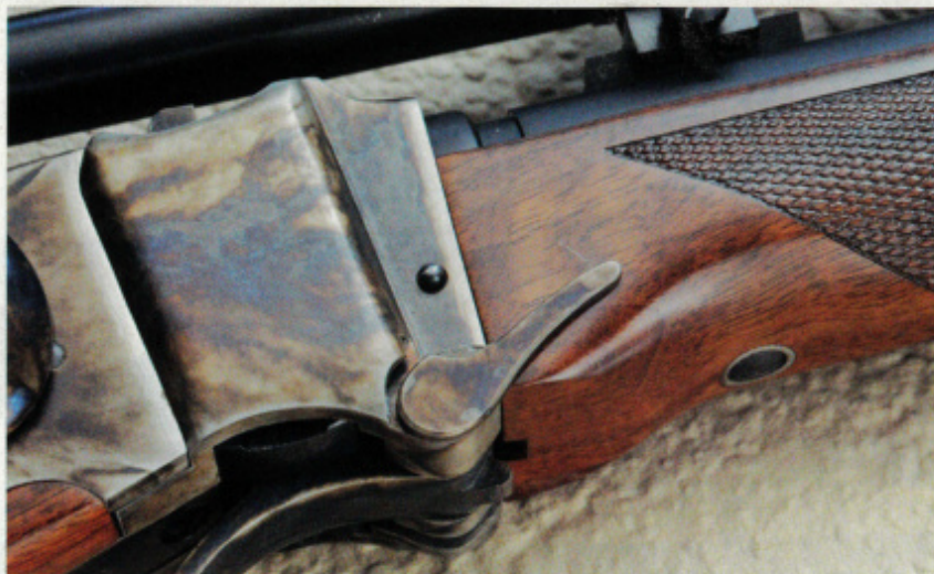
Ruotando la maniglia è possibile sfilare il perno
