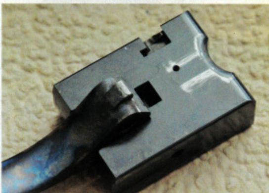
La faccia anteriore dell'otturatore è completamente piana
