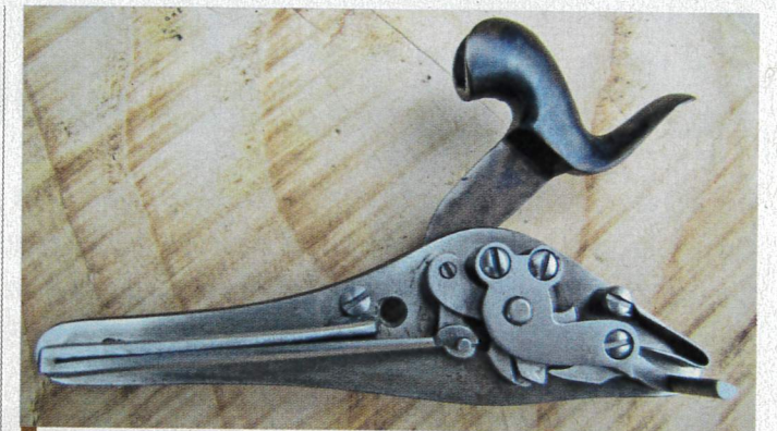
Chien à l'armé : la brièveté de sa course est un point important sur un pistolet de match. La noix possède un cran de demi-armé et un "fly" (ou séparateur) évitant que le chien ne s'y bloque en cours d'abattu. La forme de cette noix, avec un bras de levier recevant le haut de la chaînette, est typique des platines de match.
