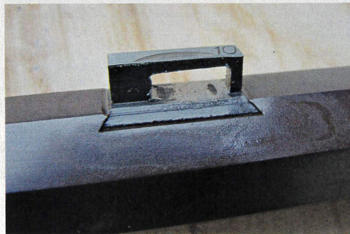
La forte attache montée à queue d'aronde sous le canon reçoit la clavette d'assemblage.
