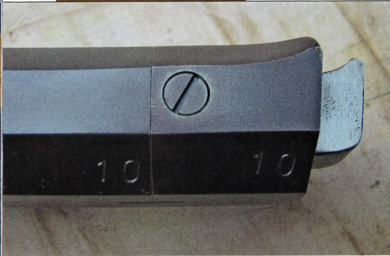
À gauche du bouchon de culasse, une vis de visite facilite le nettoyage de la chambre à poudre. Noter le crochet destiné à s'engager dans la face antérieure de la fausse culasse.
