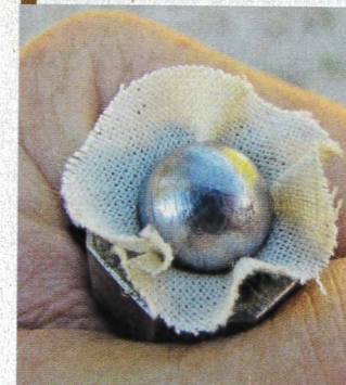
Calepin circulaire en coton épais de 0,25 mm pour 28 mm de diamètre et balle ronde en plomb de calibre .435" : une combinaison de chargement qui a fait ses preuves.
