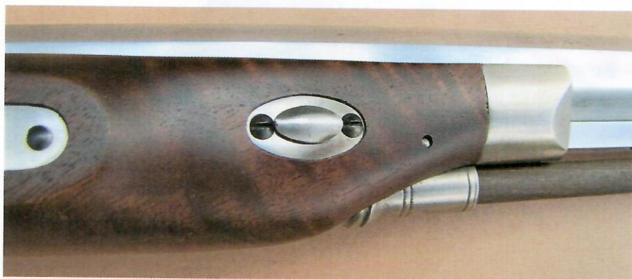
La clavette traversant la bride sous le canon assure un montage solide, exempt de jeu. Les écussons sont encastrés avec une belle précision. Un peu en avant, on voit la goupille fixant le guide baguette.
