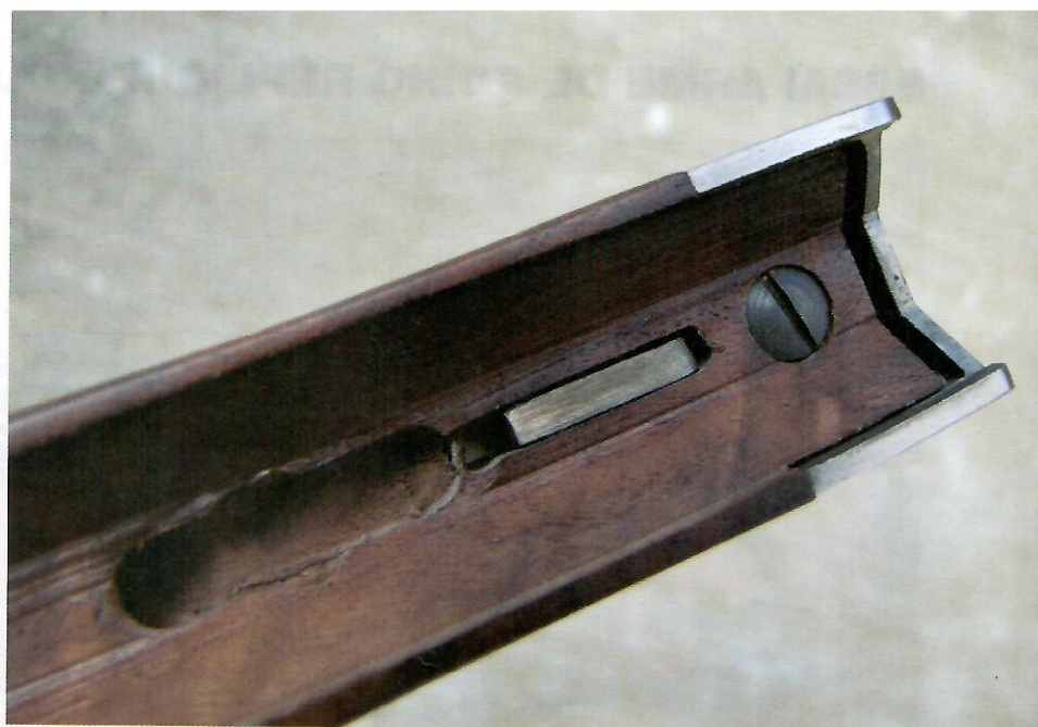
L'embout en acier poli est maintenu par une vis placée à l'avant du bedding du canon. À l'arrière, on peut voir le haut du guide goupillé latéralement dans le bois.
