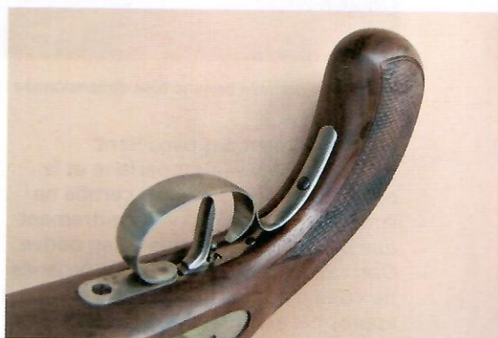
Le montage du pontet ovale est parfait.
